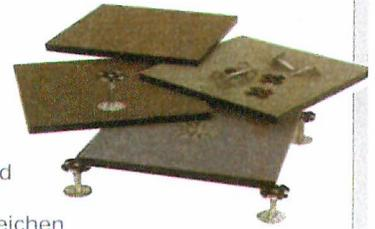
Bereiche mit **höheren Belastungsanforderungen** können Rasterprofile in die Standard-Unterkonstruktion eingesetzt werden. Sie erhöhen die Tragfähigkeit und können Horizontalkräfte aufnehmen. Ideal in Fahrbereichen oder bei großflächigen Montagearbeiten im Doppelboden. Beim Entnehmen von Doppelbodenplatten sichert das Rasterprofil die Seitenstabilität der Unterkonstruktion. Eine solche Verstärkung des Bodens ist auch nachträglich bzw. in Teilbereichen möglich.
